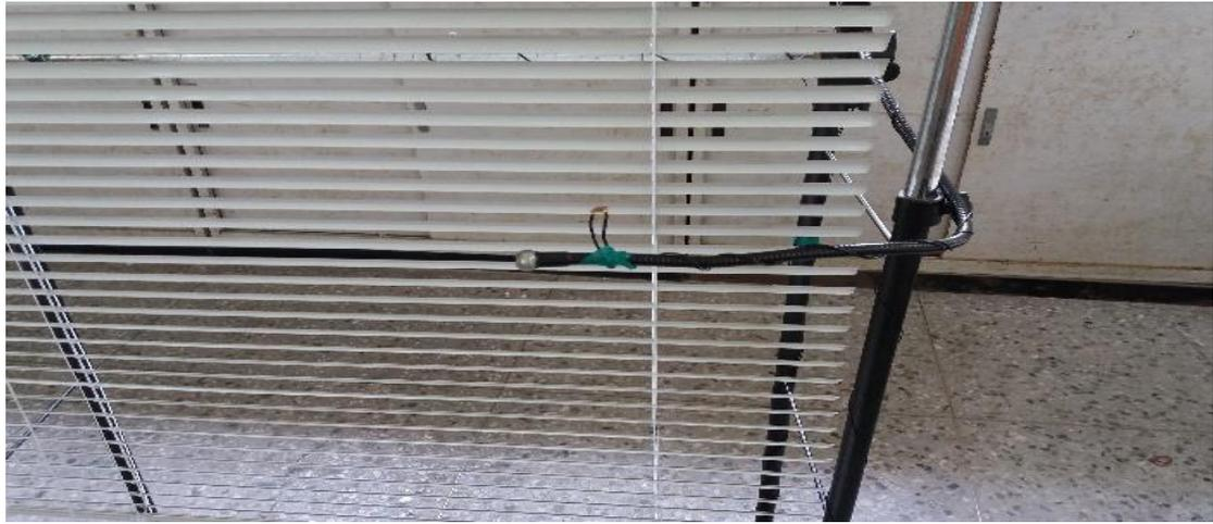
圖(15)前面偵測室外的光敏電阻
