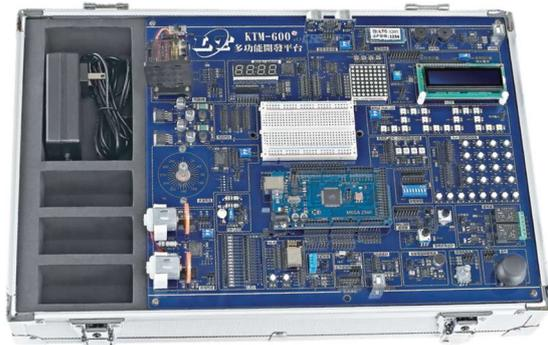
圖 11 智慧居家監控實習的開發板
