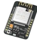
圖 17 ESP32CAM 模組[6]
