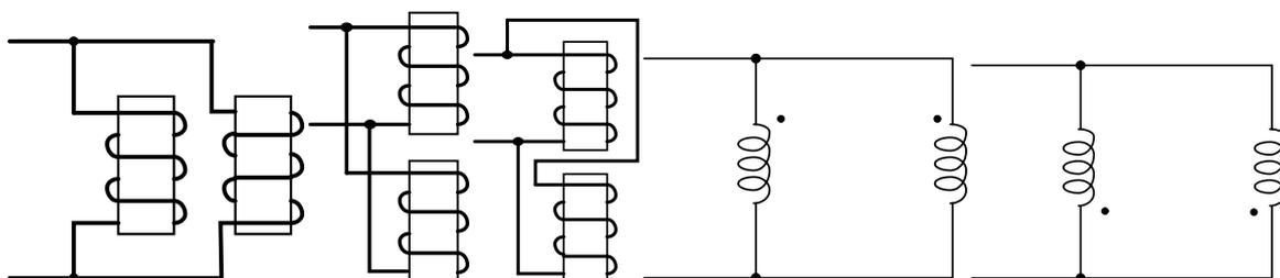
8. 並聯互消型式的電路連接與電路符號
