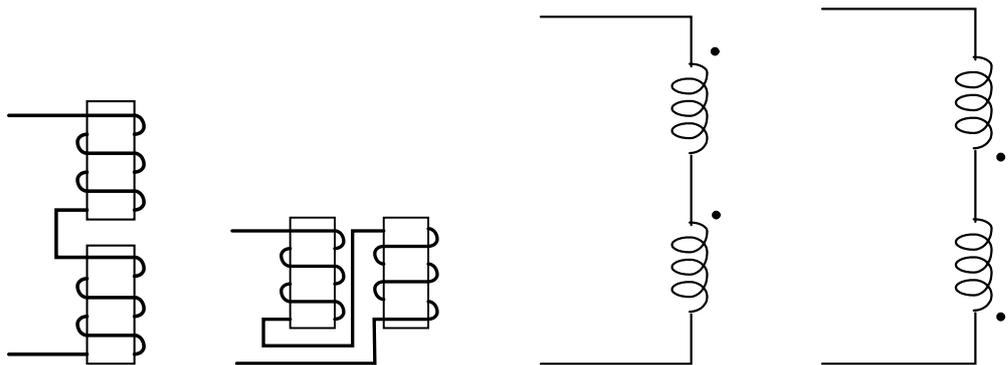
6. 串聯互消型式的電路連接與電路符號
