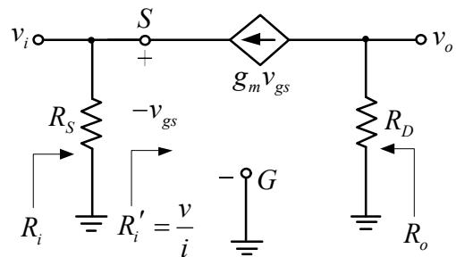
$$R_i = R_S // R'_i = R_S // \frac{v}{i} = R_S // \left( \frac{-v_{gs}}{-g_m v_{gs}} \right) = R_S // \left( \frac{1}{g_m} \right)$$
